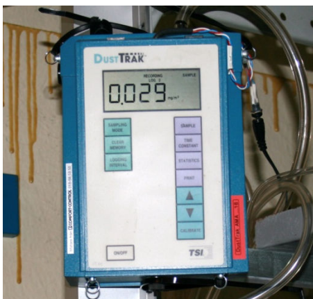
Figur 7. En av de Dust-trak, som användes under mätningarna. Slangen som syns i bild är en typisk Dust-Trak slang
