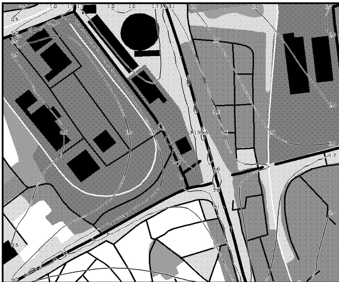
Figur 4.1 Resultat av spridningsberäkningar gjorda med gaussmodellen i Globenområdet under vintersäsong. Enheten är \mu\text{g}/\text{m}^3 .
