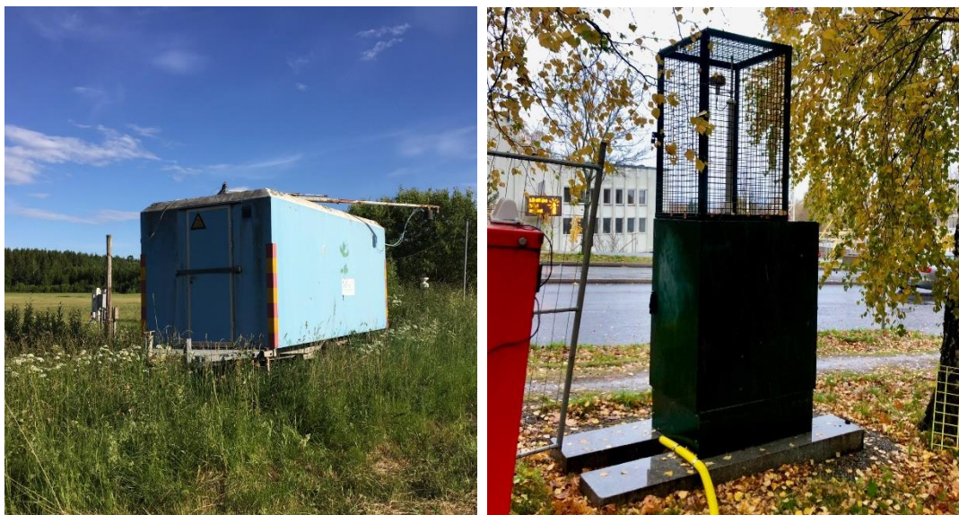
Figur 1. Mätstation Norr Malma, strax norr om Norrtälje, mätutrustningen är placerad i en mätvagn (vänster bild). Mätstation på Sollentunavägen 192 i Sollentuna, mätutrustningen är placerad i ett mätskåp med bur som skyddar insug (höger bild).
