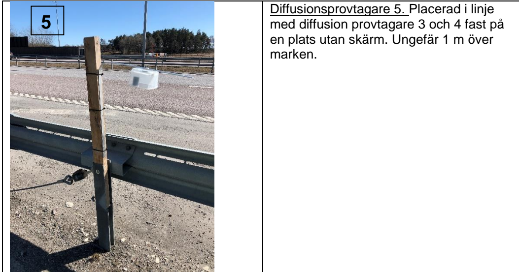
Figur 8. Placering för diffusionsprovtagarna intill Norrortsleden. De har samma benämning som i Figur 5 och Figur 6.
