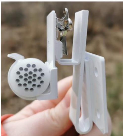
Figur 1. Ogawa provtagare för NO_x och NO_2 från Umeå universitet
