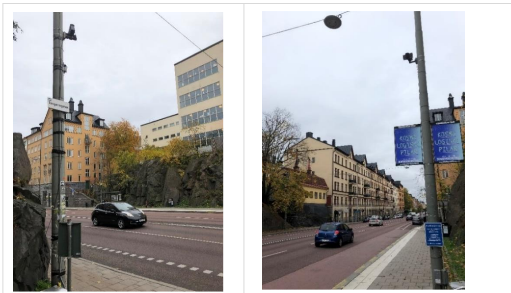
Figur 3. Placering av sensorer för avläsning av fordonens registrerings skyltar per köriktning på Hornsgatan i höjd med Ansgariegatan. Facility Labs AB.
