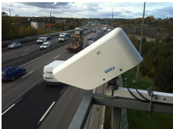
Figur 4. Placering Vaisala Remote Road Surface State Sensor (DSC111) instrument för mätning av vägbaneförhållandet på Essingeleden, vid E4/E20 Gröndal.
