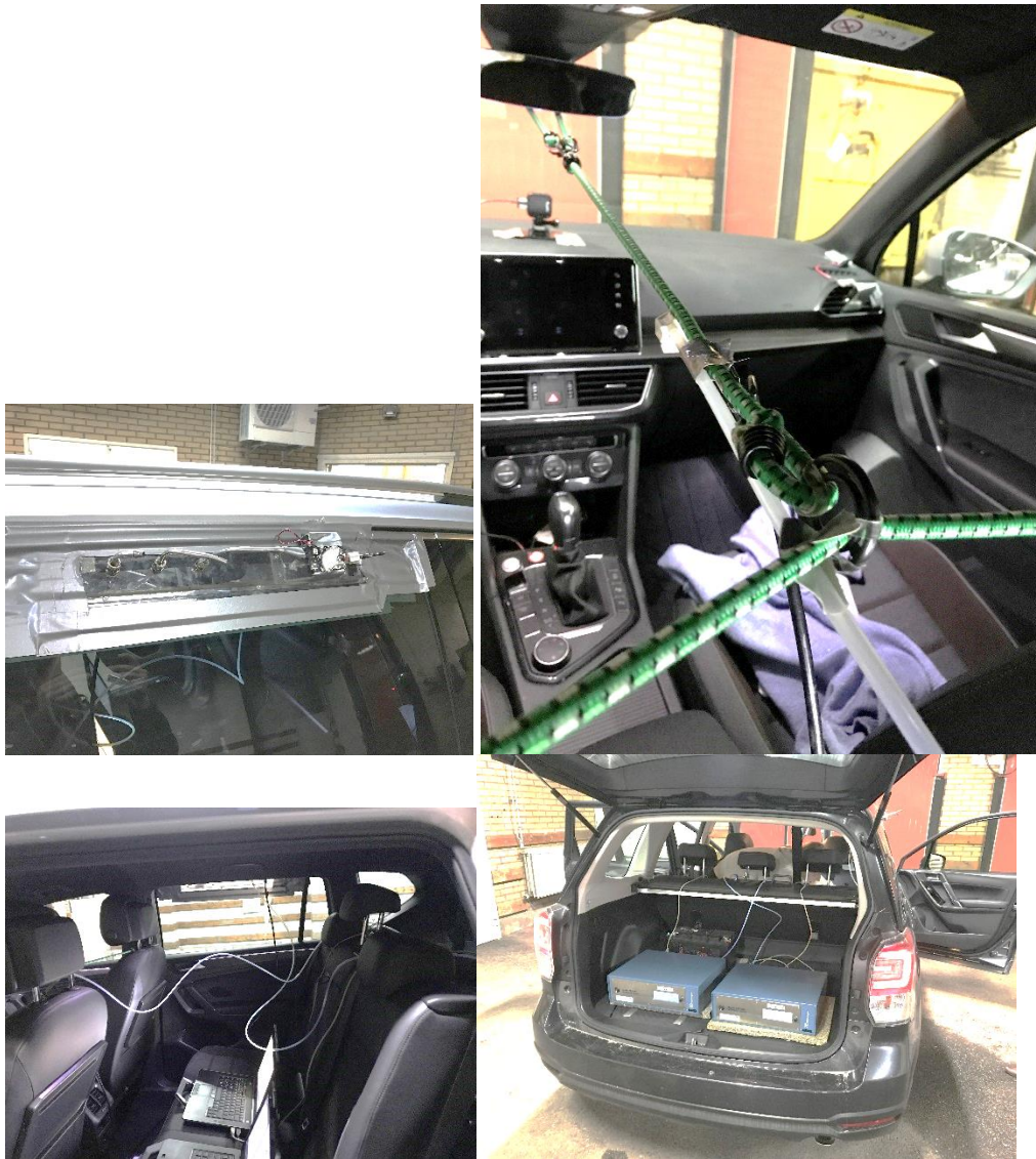
Figur 3. Luftinsugens placering i och utanför bilen samt övrig mätutrustnings placering.
