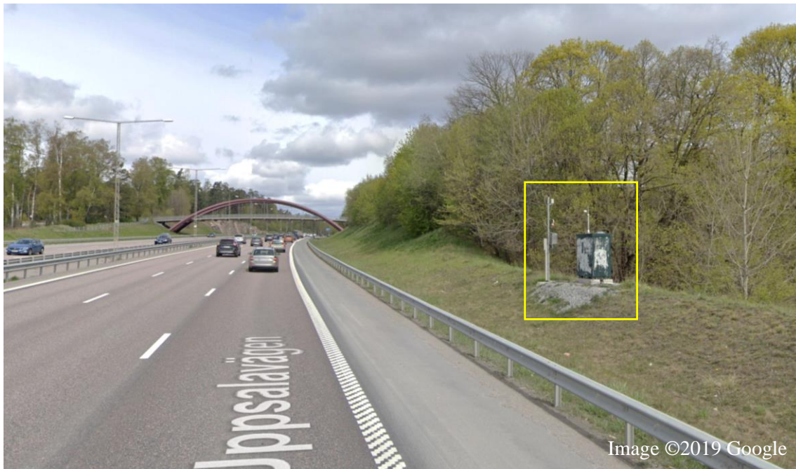
Figur 2. Mätstationen Rotsunda vid teststräckan med bullerreducerande asfaltsbeläggning av typen ABD 11.
