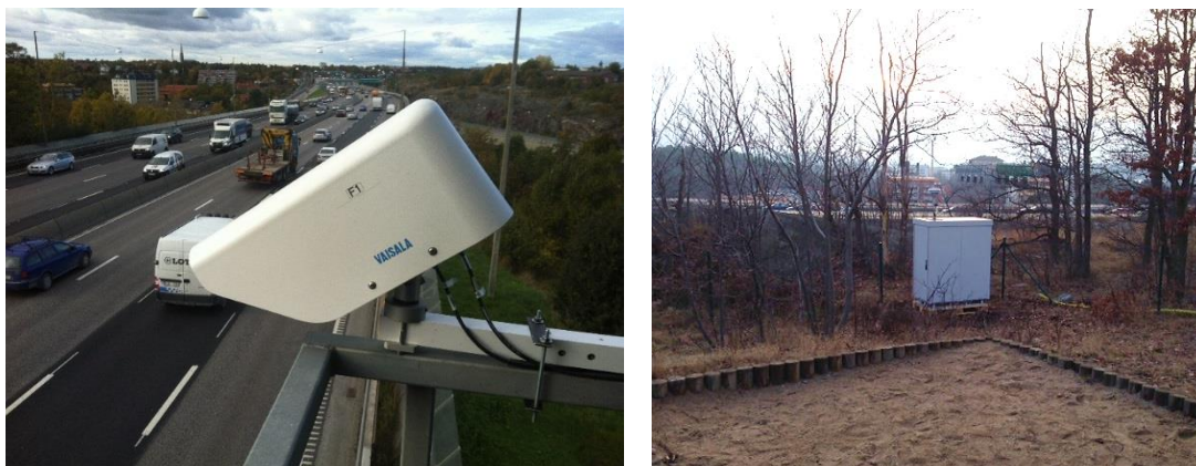
Figur 5. Placering av mätstationen vid skolgården till Gröndalsskolan jan-dec 2014, och Vaisala Remote Road Surface State Sensor (DSC111) instrument för mätning av vägbaneförhållande på Essingeleden E4/E20 Gröndal.
