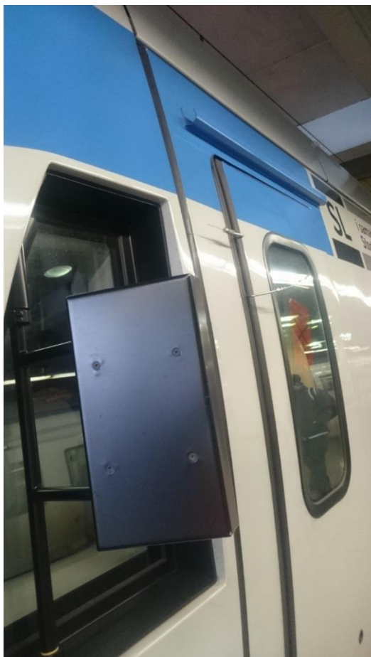
Figur 2. Foto över rör använda till utomhusmätning. Observera två rör vars användning växledes beroende på färdriktning.
