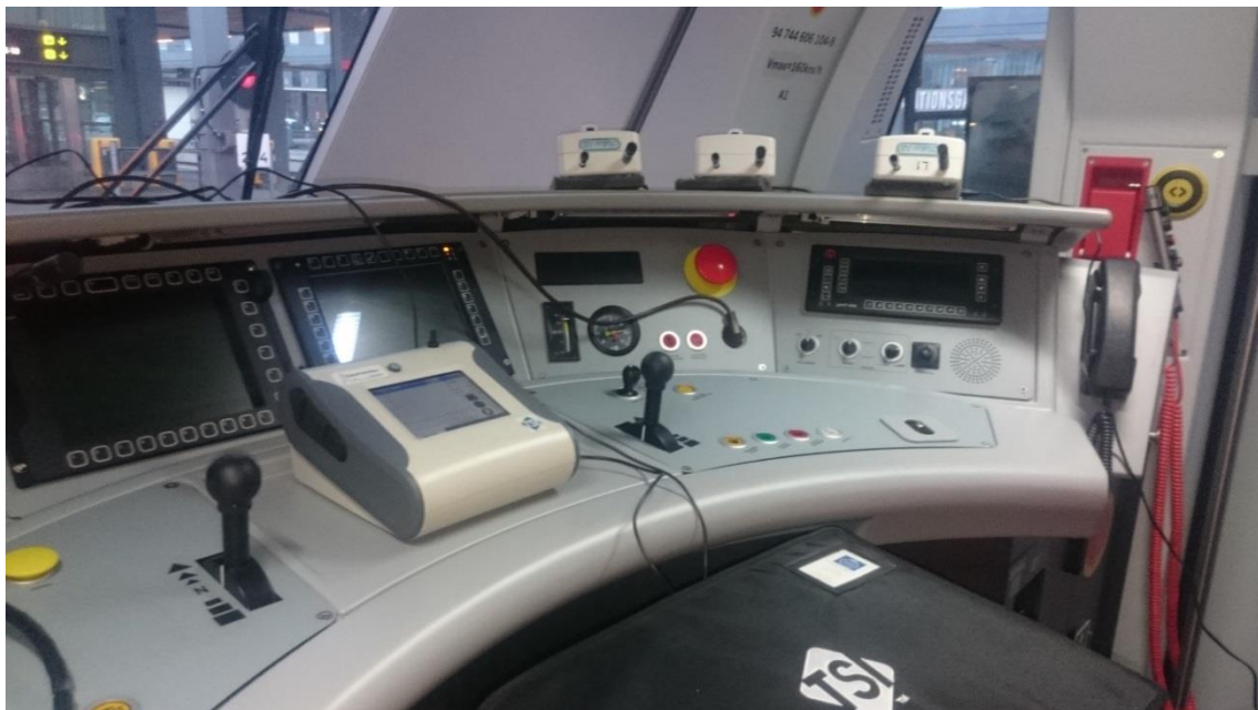
Figur 1. Foto över mätuppställning vid parallellmätning med tre Lighthouse instrument och OPS 3300 (som ej utnyttjades i analysen). Lighthouse-instrumentet längst till höger motsvarar dess placering vid mätning i förarhytter.
