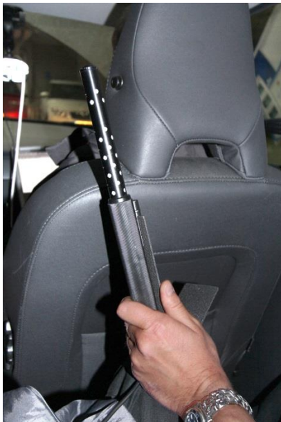
Figur 1. Placering av instrumentinsug bakom högra framsätet i Volvo V70 (vid fem personer i fordonet).
