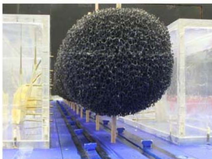
Figur 8. Försöksuppställning med träd längs en ”gata” i vindtunnelstudien av Gromke & Ruck (2007).
