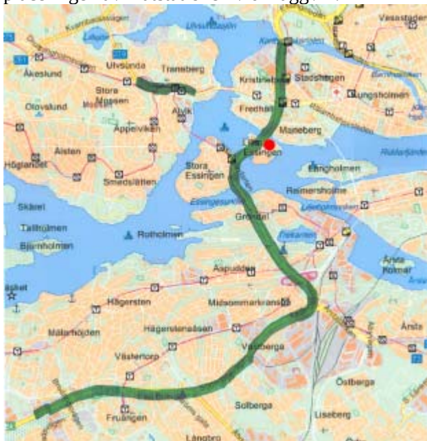
Figur 20. Behandlade sträckor med MgCl_2 längs E4/E20 söderut och väg 275. Den röda punkten markerar placeringen av mätstationen vid L:a Essingen
