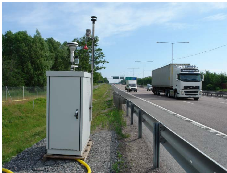
Figur 3. Den fast mätstationen för mätningar av PM10- och NOx-halter samt meteorologi intill provbeläggningen i Hallunda (mätplats A i Figur 2).
