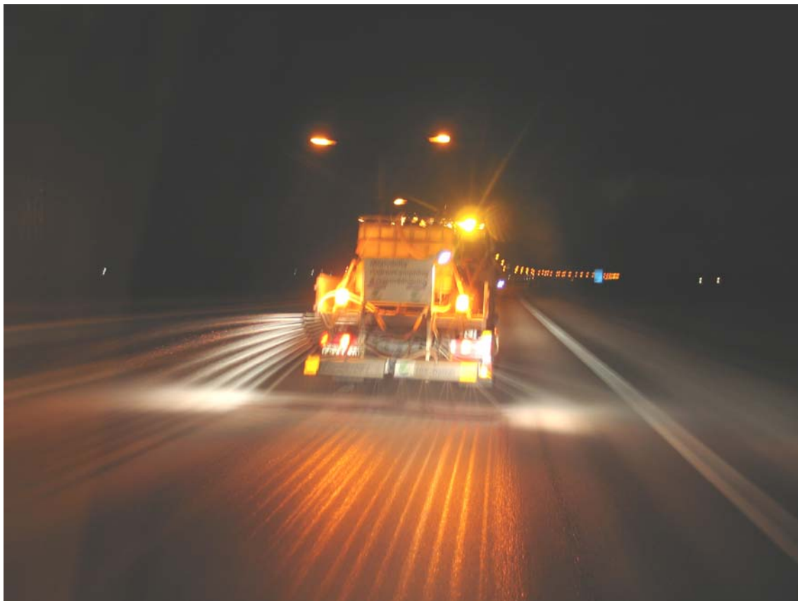
Figur 3. Spridare för dammbindningstester i halkbekämpningsarbete. I detta fall sker spridning längs motorvägen.
