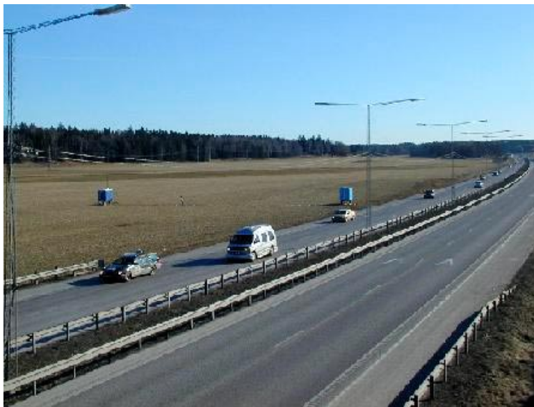
Figur 8. Mätvagnarna vid Vallstanäs 2003. Den närmast vägen benämns E1 och den ca 50 meter in på åkern benämns E2. Dessutom finns en mätstation på västra sidan vägen som ej syns på denna bild (W1).
