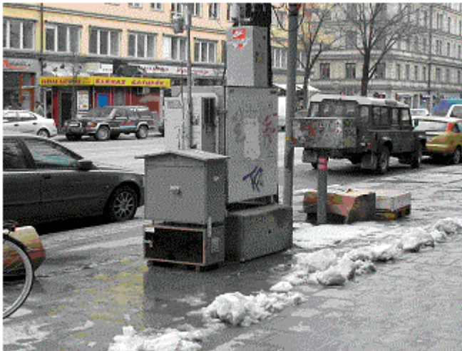
Figur 7. Mätstationen på Sveavägen. Mätparametrar: PM10, PM2.5, NO, NO 2 , CO och under en mätkampanj även partiklarnas grundämnessammansättning.
