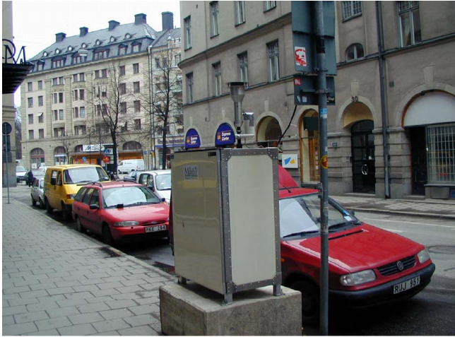
Figur 6. Mätstationen på Norrlandsgatan. Mätparametrar: PM10, NO, NO 2 , temperatur, relativ fuktighet och gatans fuktighet.
