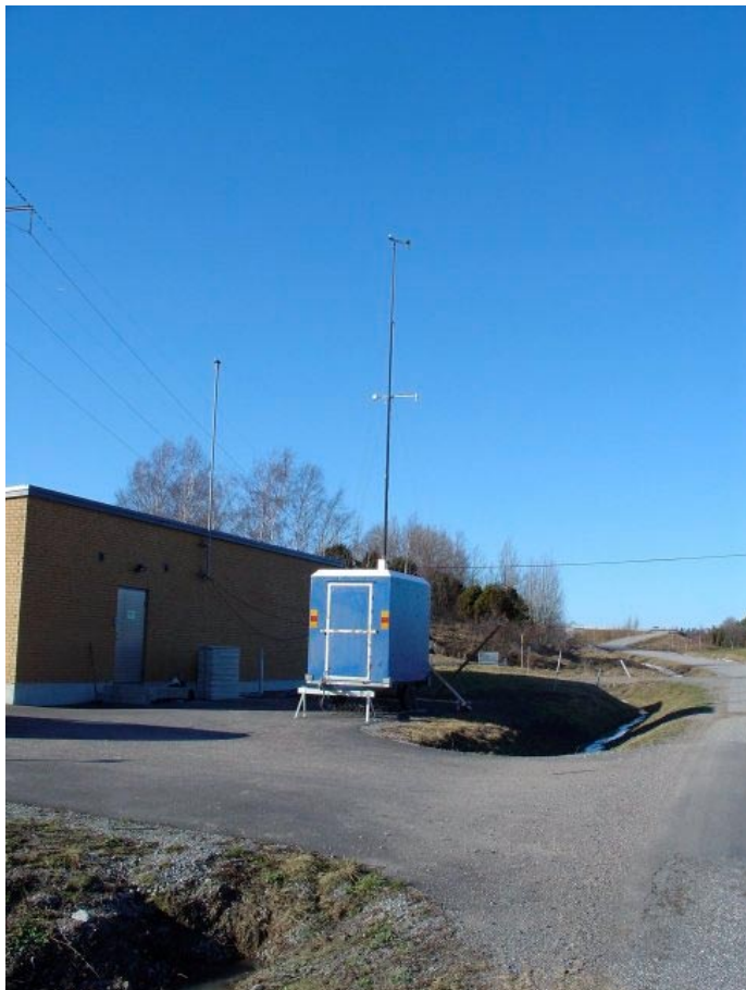
Figur 11. Mätvagn med meteorologiska mätningar längs E4'an vid Vallstanäs. Mätparametrar: vindriktning, vindhastighet, temperatur, temperatur differensen mellan 7 och 1 m samt relativ fuktighet.
