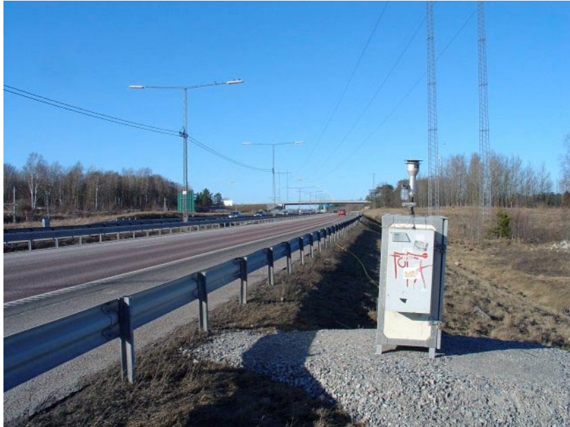
Figur 10. Mätstation längs E4'an vid Vallstanäs. Vid alla tre punkterna mätes PM10 och vid en station även NO och NO 2 .
