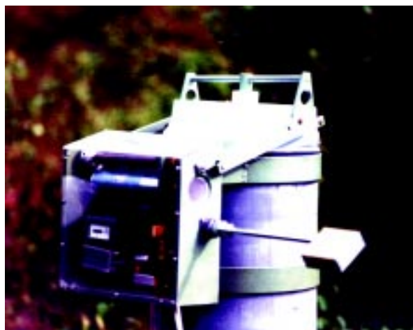
Figur 2b. Nederbördsinsamlare försedd med lock. Locket lyfts automatiskt av vid nederbörd. Insamlaren är utvecklad och tillverkad vid Meteorologiska institutionen vid Stockholms universitet.
