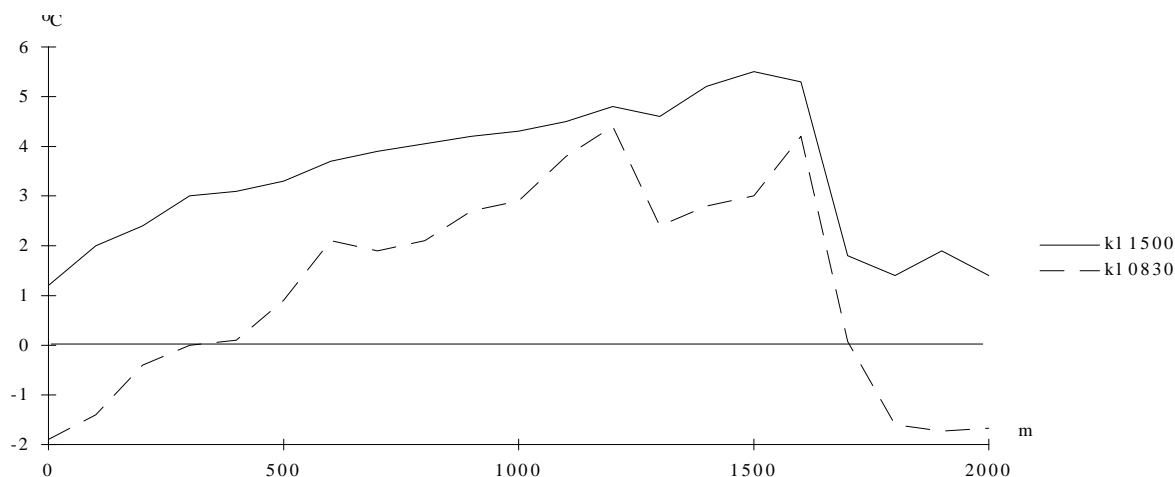
Figur 18: Temperaturförlopp i tunneln.
