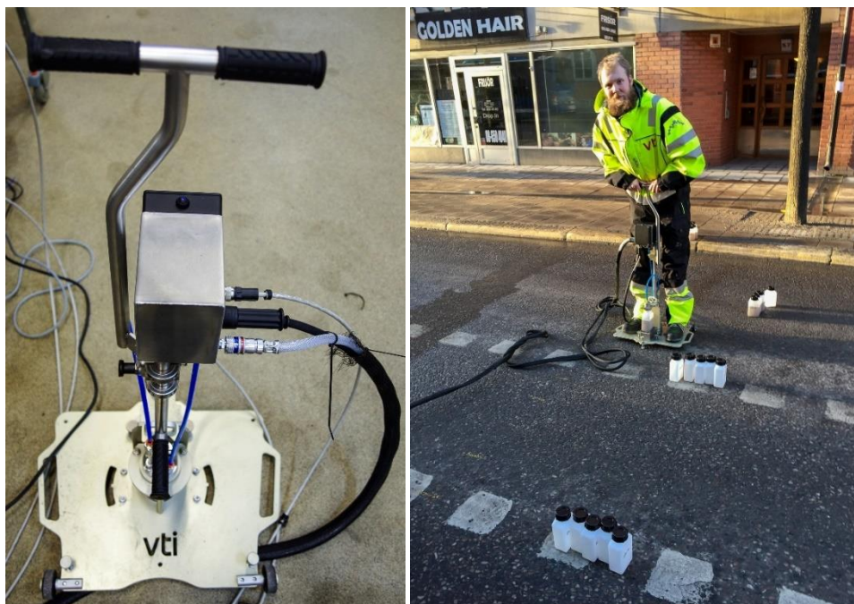
Figur 12. Vägdammsprovtagaren Wet Dust Sampler II (WDS II). (Foto: Mats Gustafsson, VTI).
