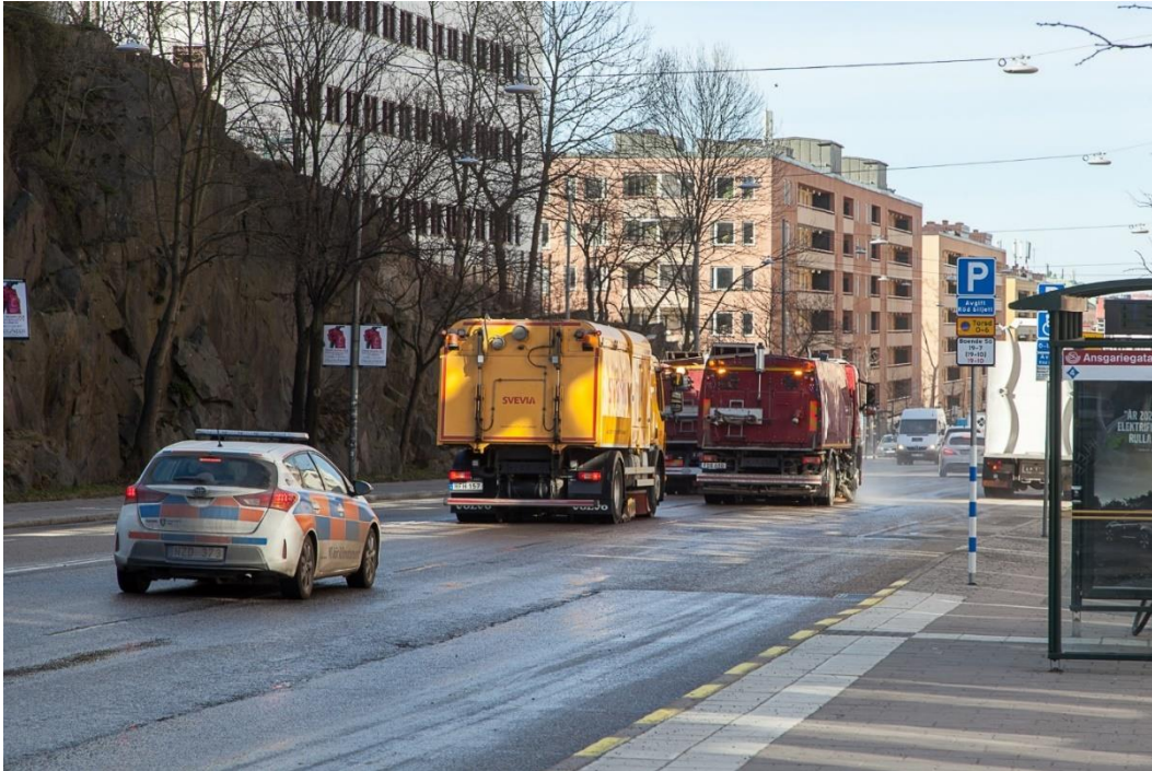
Figur 4. Spolning och efterföljande vakuumsugning på Hornsgatan. (Foto: Mats Gustafsson, VTI).
