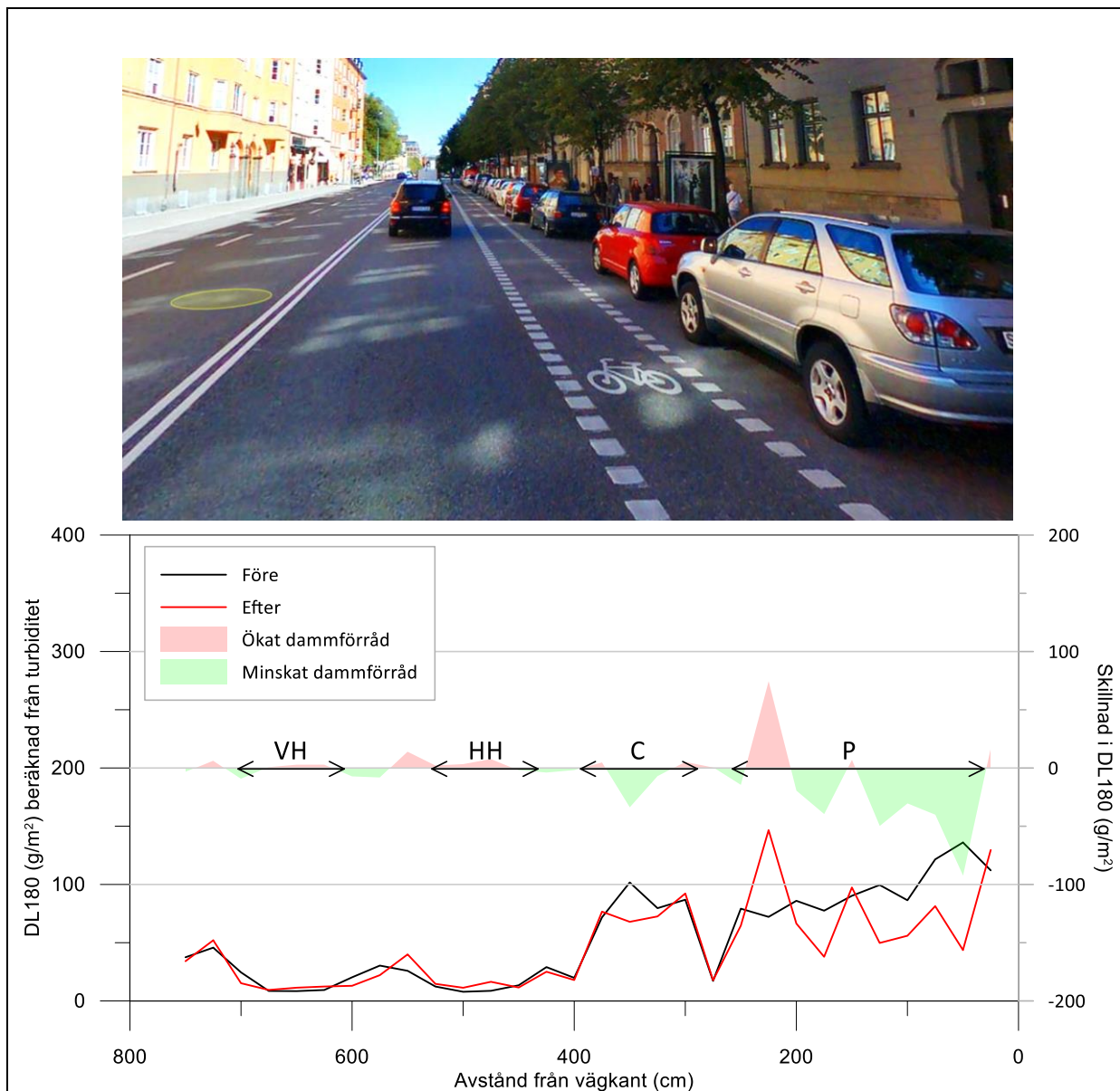
Figur 15. Dammförrådet i en profil tvärs östgående körfält på Fleminggatan vid enbart spolning med vatten. Gröna och röda fält visar var dammförrådet har minskat respektive ökat. VH=vänster hjulspår, HH=höger hjulspår, C=cykelbana, P=parkeringsyta. (Foto från eniro.se).
