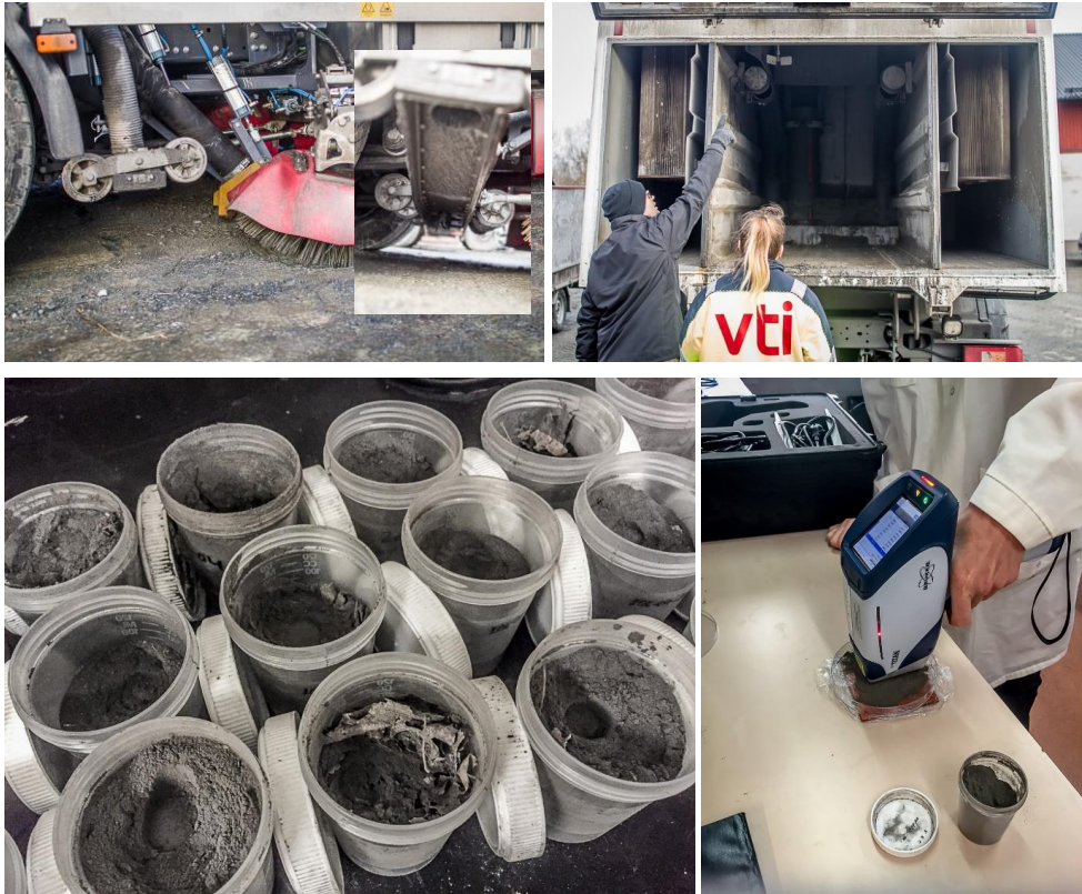
Figur 7. Vakuumsugens insug (över till vänster), uppsamlingsbehållare (över till höger), insamlade dammprover från vakuumsugen (nere till vänster) och XRF-mätning på prov (nere till höger). (Foto: Göran Blomqvist, VTI).
