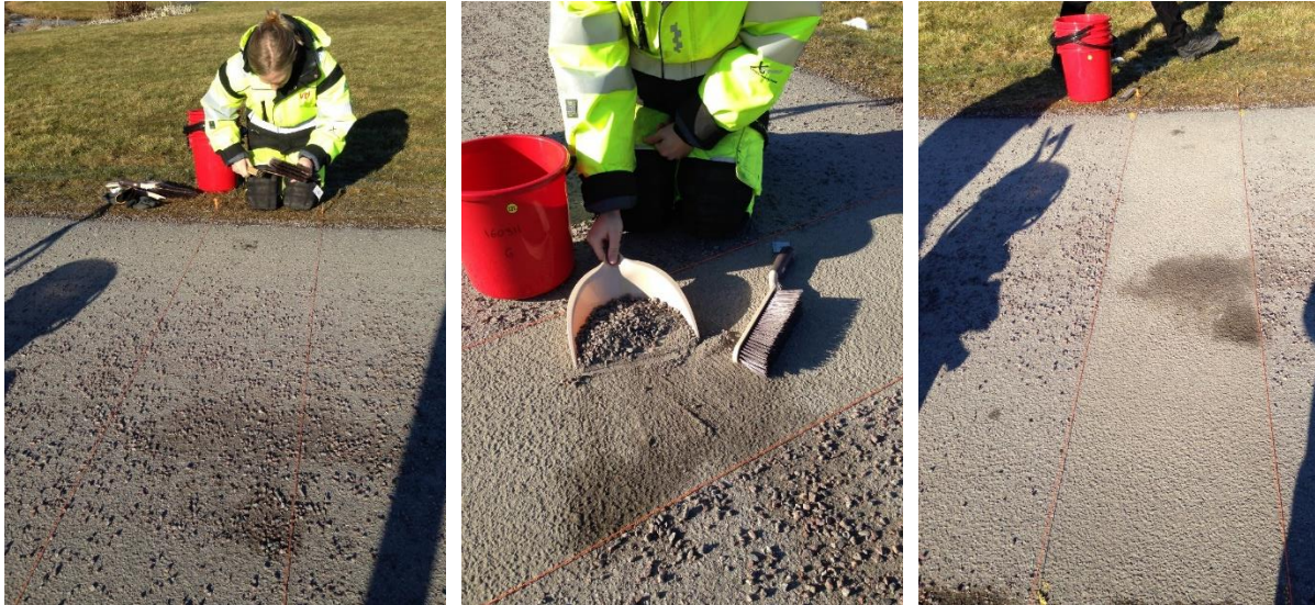
Figur 6. Tillvägagångssätt vid sandprovtagning från gång- och cykelbana i Linköping våren 2016. (Foto: Göran Blomqvist, VTI).
