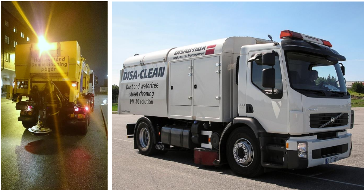
Figur 1. Dammbindningsbil med tallriksspridare och vakuumsugen Disa-Clean från DISAB-Tella. (Foto: Carl Södergren och Mats Gustafsson, VTI).
