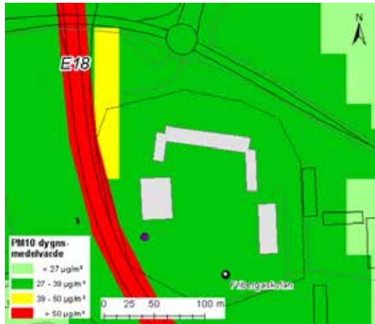
Figur 8. Beräknade halter av PM10 vid Fribergaskolan år 2010, då inkluderat en höjdskillnad mellan E18:s vägbanor och skolområdet. Den lila punkten visar placering av mätplatsen för mätningarna under 2011/2012 och 2012/2013. PM10 som medelhalt ( \mu\text{g}/\text{m}^3 ) under det 36:e värsta dygnet. Normvärde som ska klaras är 50 \mu\text{g}/\text{m}^3 .
