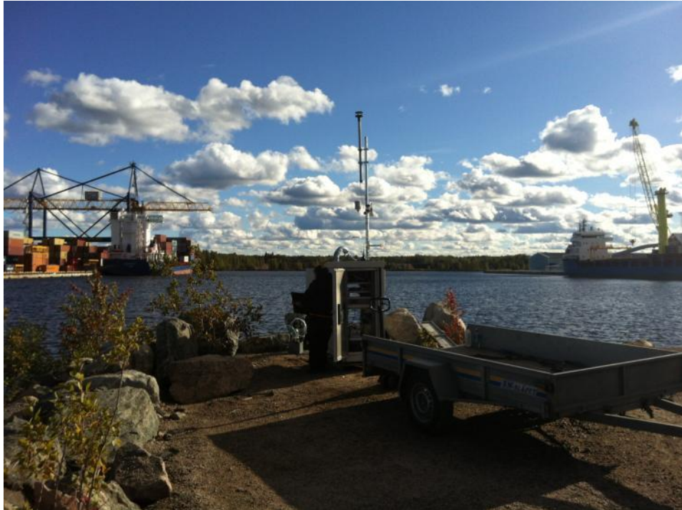
Figur 4. Placeringen av mätstationen i Gävle hamn mitt i hamnbassängen. Den meteorologiska masten är placerad på skåpet.
