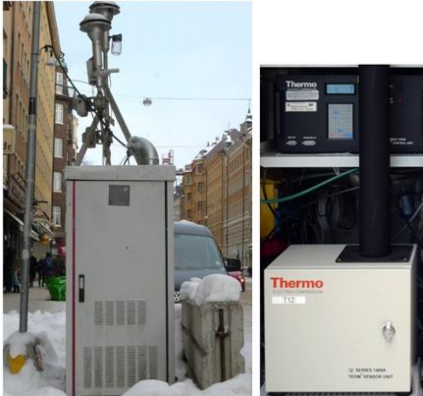
Figur 1. TEOM Rupprecht & Pataschnik Co, Series 1400a med provluftväxlare
