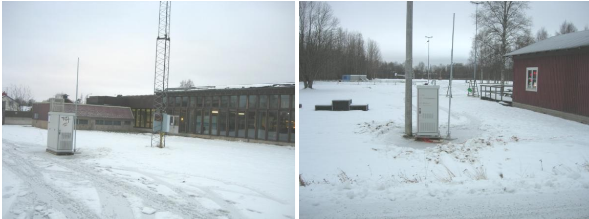
Figur 2. Bilder på mätplatsen vid Gammlia (vänstra bilden) och Ön. Vindmätningarna görs på toppen av den 3,5 meter höga masten med hjälp av en ultraljuds anemometer. Dessutom mäts temperatur och relativ fuktighet.
