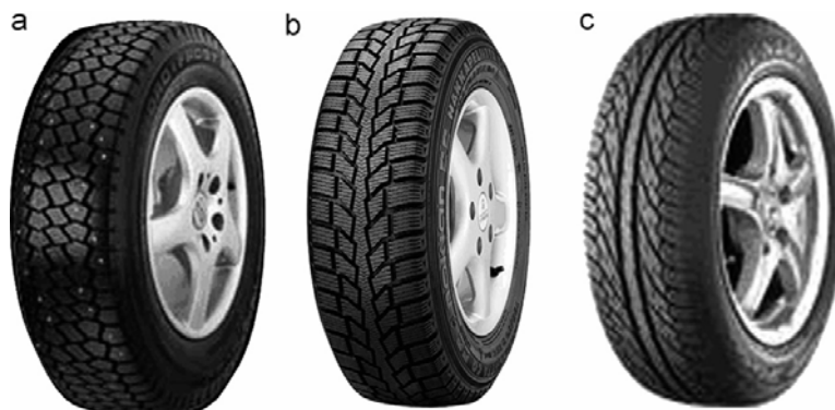
Figur 4. Däck som använts i denna studie: a) dubbdäck Gislaved Nordfrost C, b) friktionsdäck Nokian Hakkepelitta CQ, c) sommardäck Dunlop SP LT8.
