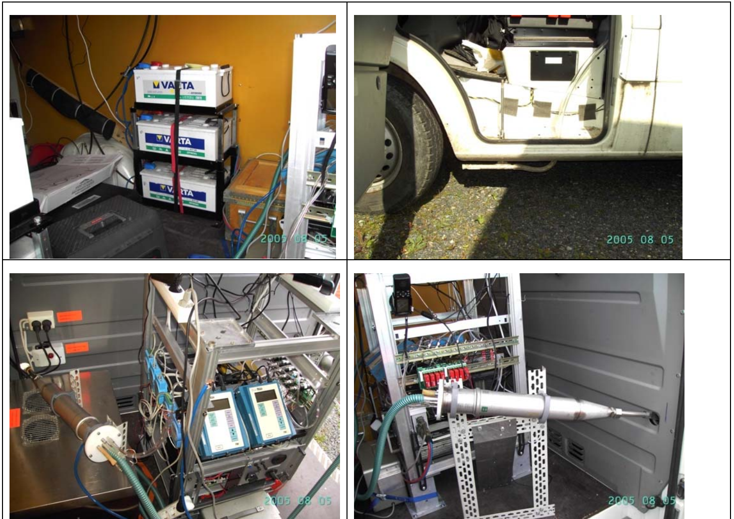
Figur 2. Batterier (över vänster), Luftintag bakom framhjul (över högre), instrumentrack med Dust Trak (nedre vänster) och insugsfördelare inne i bilen (nedre höger).
