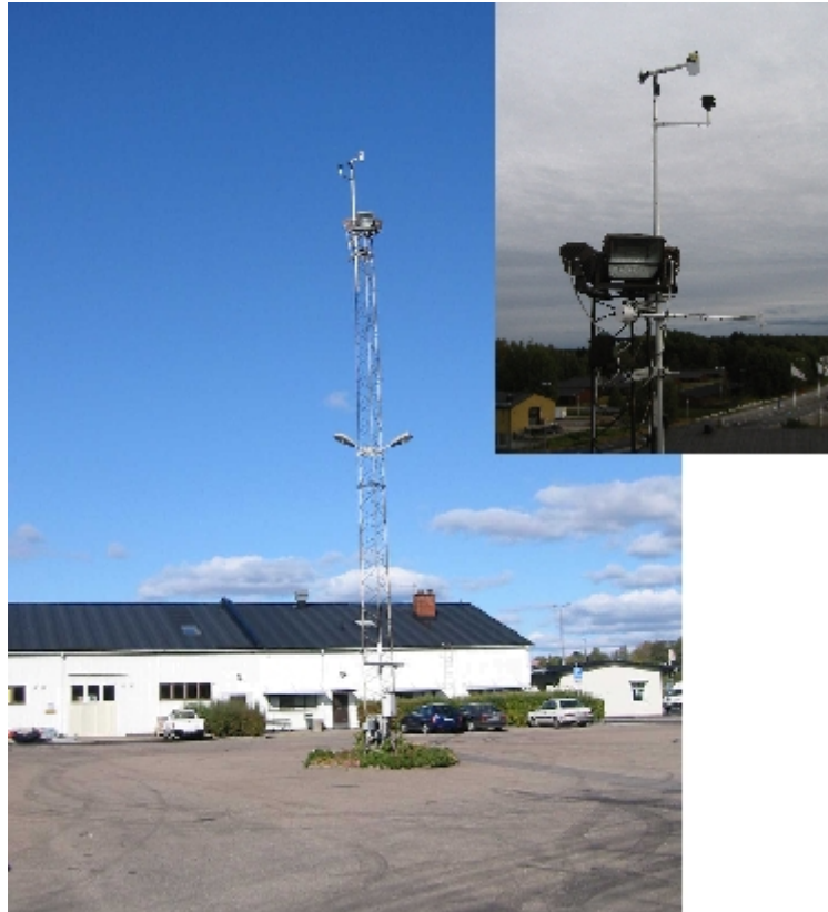
Figur 4. Den tillfälliga meteorologiska stationen vid Tekniska förvaltningen vid Söderleden i Växjö.
